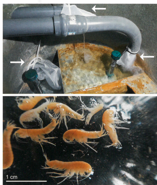
Beprobung von Quellfassungen. Oben: montierte Filternetze an Einlaufrohren einer Brunnenstube; unten: gesammelte Grundwasserflohkrebse. Dabei braucht es die Mithilfe von Wasserversorgungen und Brunnenmeistern.
